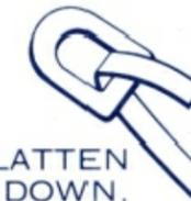
2.— PASS BAND AROUND WORK AND THROUGH YOKE.
